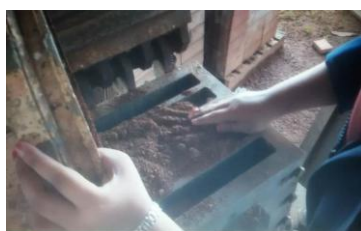
Rajah 7: Proses memasukkan sampel ke dalam kotak bentuk untuk dipadatkan
