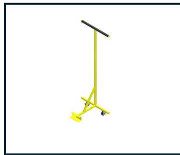
Rajah 3.1: Model reka bentuk alat angkat beroda untuk kereta formula elektrik.
